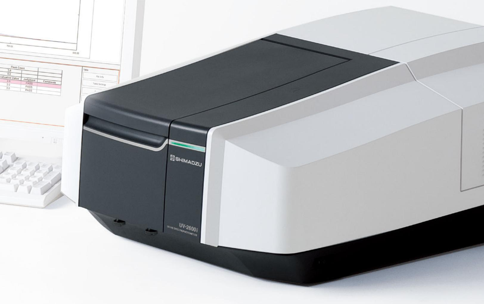
Измерения коэффициентов пропускания/отражения многослойной диэлектрической пленки с помощью многофункционального кюветного отделения MPC-2600A в комплекте с приставкой с переменным углом падения света UV-2600i
